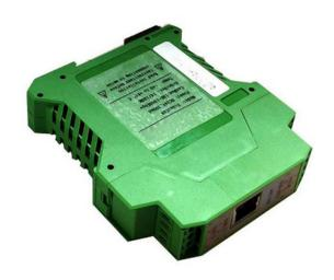
微气象在线监测装置主机会将采集的温度、湿度、风速、风向、气压等等微气象数据经过数字化、压缩编码后,通过4G/3G/GPRS/CDMA无线网络、电力专网发送到监控中心,在监控中心上对数据信号进行解码,即可将微气象数据通过数字和图表形式直观显示在屏幕上。具体为,通过远程数据采集器采集输电线路周围的温度、湿度、风速、风向、气压数据,然后把数据进行数字化压缩编码,利用4G/3G/GPRS/CDMA无线网络传输模块将现场数据以IP包的方式发送到数据监控服务器。
